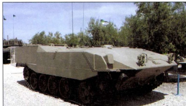
4. ábra: Achzarit nehéz páncélozott csapat szállító jármű. A képen látható példányról hiányzik a fegyverzet ( http://idf-modelling.free.fr/achzarit.html )
