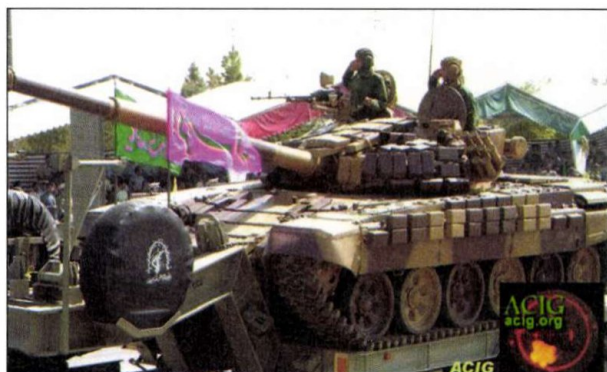
5. Az eredeti T-72 harckocsi iráni gyártású ERA reaktív páncélzattal felszerelve
