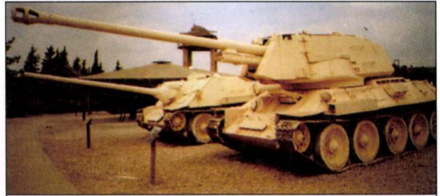
5. ábra: Egyiptomi zsákmányból származó, 100 mm-es löveggel felszerelt T-34-es páncélvadász. Az M1944(BS-3) löveget a harckocsi eredeti tornyába építették be!
