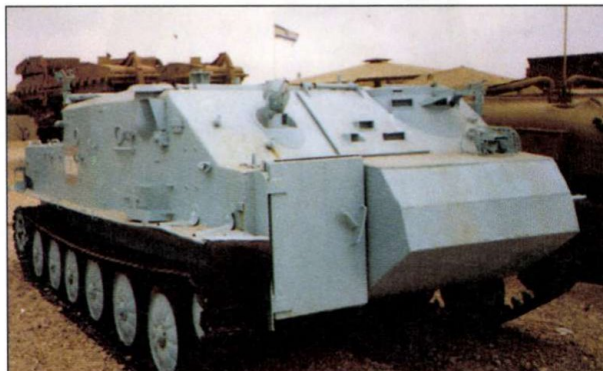
3. ábra: Libanoni zsákmányból származó, módosított BTR-50-es sebesültszállító jármű. Figyelmet érdemel a harcjármű elejének jobb oldalán kialakított nyílás, mely a hordályok ki- és beadására szolgált
