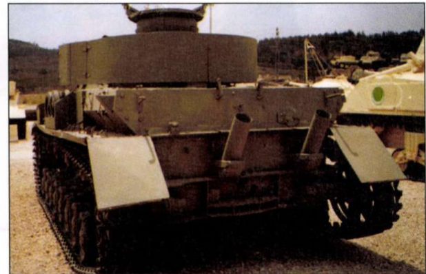
7. ábra: Panzer IVJ hátulról. Érdekesség, hogy az ismertető Panzer IVG-ként jelzi a harckocsit, noha a kipufogórendszer alapján egyértelműen azonosítható, hogy a J változatról van szó
